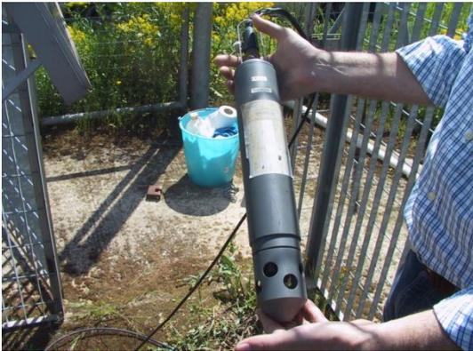
Figura 5.4 – Sonda multiparametrica
