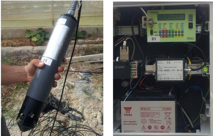
**Figura 4.2** Sonda multiparametrica e stazione con datalogger per registrazione dei dati
