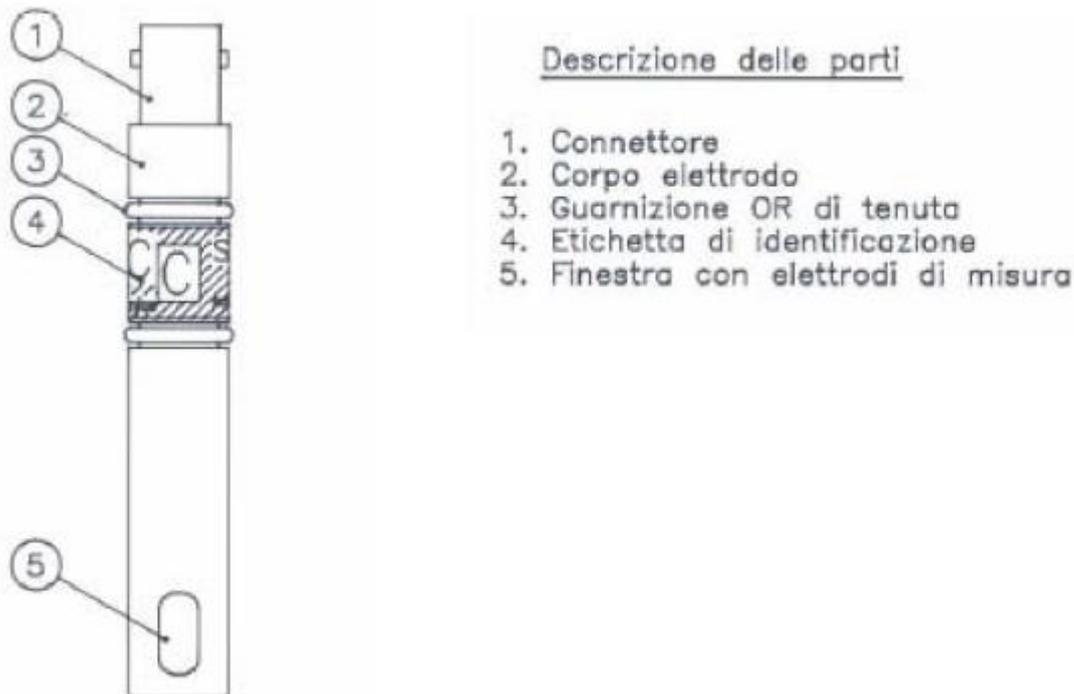
**Figura 7.7** Sensore di conducibilità elettrica
