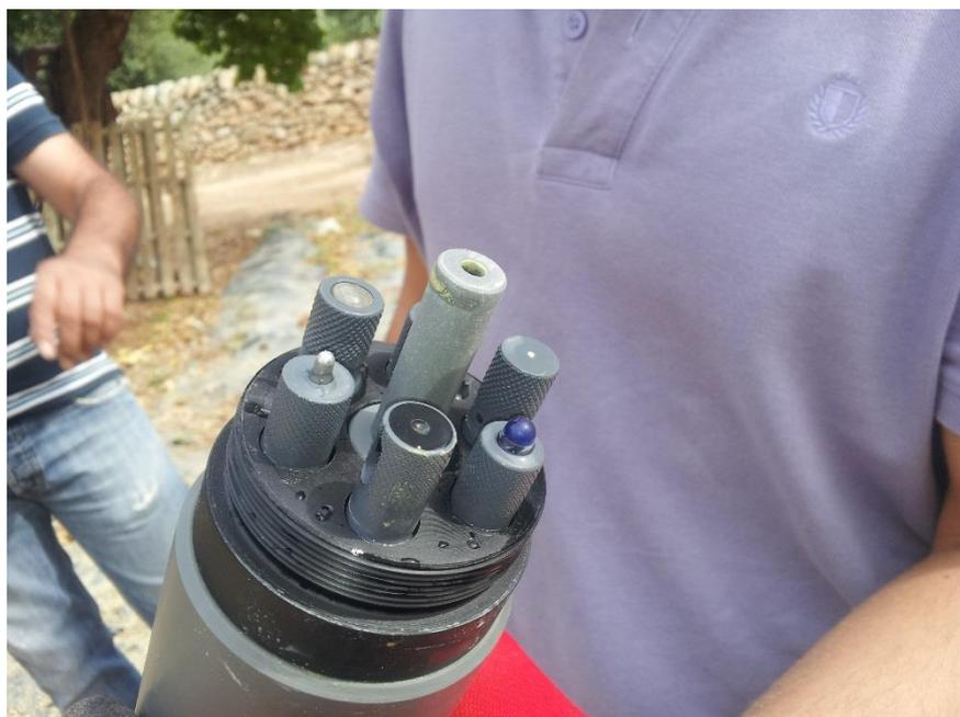
**Figura 4.6** Particolare della sonda multiparametrica installata presso la rete di monitoraggio
