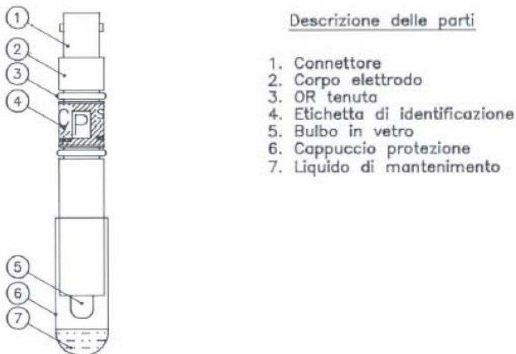
**Figura 7.8** Sensore di pH
