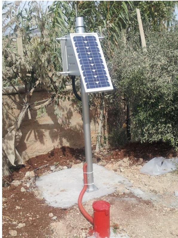
**Figura 4.4** Stazione di monitoraggio delle acque sotterranee del territorio ibleo
